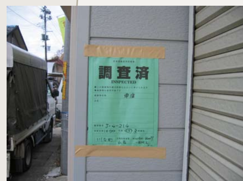
Diagnostic de l'état du bâti et mesures de protection (vignettes colorées). Photos prises au Japon en 2004, cette méthode de diagnostic et mise en sûreté n'a pas encore été appliquée en France.
