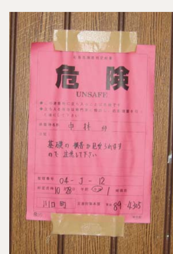
Diagnostic de l'état du bâti et mesures de protection (vignettes colorées). Photos prises au Japon en 2004, cette méthode de diagnostic et mise en sûreté n'a pas encore été appliquée en France.
